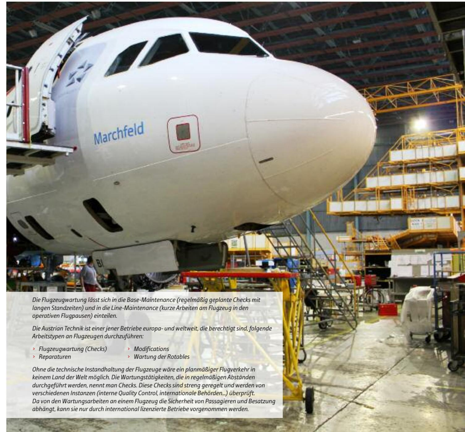
Die Flugzeugwartung lässt sich in die Base-Maintenance (regelmäßig geplante Checks mit langen Standzeiten) und in die Line-Maintenance (kurze Arbeiten am Flugzeug in den operativen Flugpausen) einteilen.
